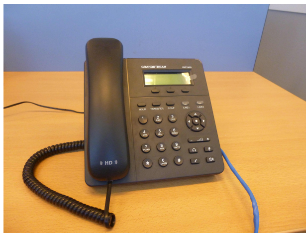
Fig. 8 Teléfono IP Grandstream GXP1400. Ubicado en oficinas de la Ciudad Universitaria.
